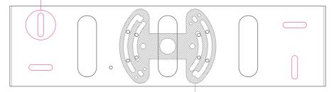
Nel caso di fissaggio a Junction Box utilizzare una piastra adattatrice In case of fixing to Junction Box use an adapter plate
