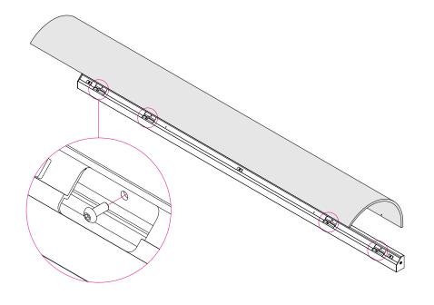
1° Passaggio - Infilare il metacrilato e fissarlo al profilo di alluminio con le viti fornite 1° Step - Insert the methacrylate and fix it to the alluminium profile with the screws supplied
