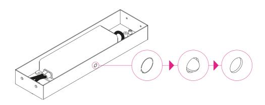
Ricavato il foro, infilare il passacavo in dotazione e inserire il cavo del rosone circolare dopo averlo tagliato della lunghezza necessaria.
