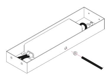
Una volta infilato il cavo nel rosone rettangolare, infilarlo nell'asola bloccacavo come evidenziato nello schema. After inserting the cable into the rectangular canopy, insert it into the cable locking slot as shown in the diagram.
