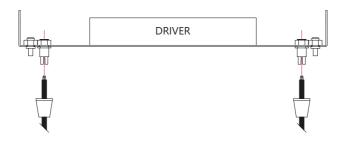
1° Passaggio - Infilare i cavi di alimentazione nei fermacavi conici. Infilare i cavi di alimentazione nel fermacavo del rosone. 1° Step - Insert the conical cable clamps on the power cable. Insert the power supply cable in the cable clamp of the canopy
