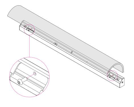
1° Passaggio - Infilare il metacrilato e fissarlo al profilo di alluminio con le viti fornite 1° Step - Insert the methacrylate and fix it to the alluminium profile with the screws supplied
