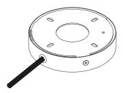
Fissare la staffa a soffitto in corrispondenza del punto di uscita dei cavi, poi connettere il cavo del rosone circolare ai cavi del soffitto.
