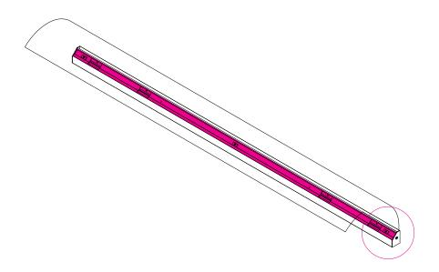
2° Passaggio - Applicare magneticamente la copertura 2° Step - Magnetically apply the cover
