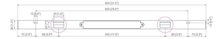
N°2 Aperture per consentire il cablaggio a parete N°2 Holes to allow wall wiring
