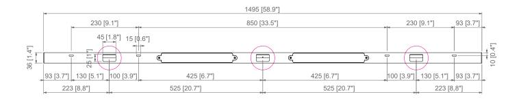
N°3 Aperture per consentire il cablaggio a parete N°3 Holes to allow wall wiring
