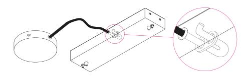
Connettere il cavo al trasformatore. Connect the cable to the driver.
